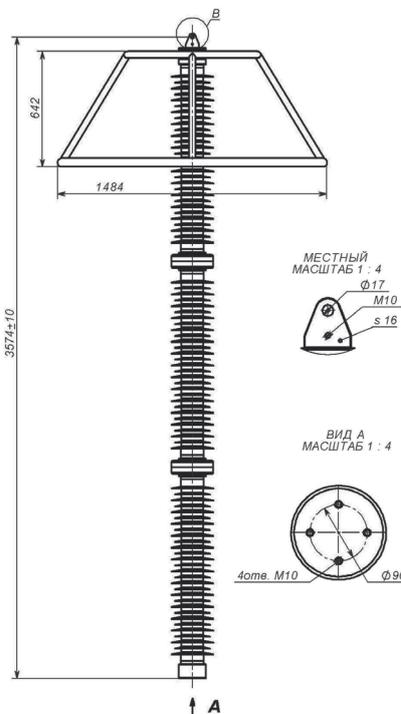
Рис.52 ОПН-330/1000-ПФ подвешеного исполнения для установки на фазный провод
