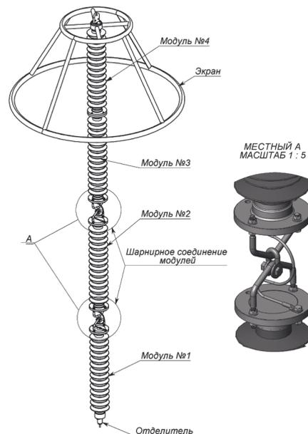
Рис.53 ОПН-500/1000-ПФ подвешеного исполнения для установки на фазный провод
