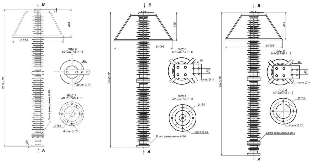
Рис.49 ОПН-220/1000 с изолирующим основанием
