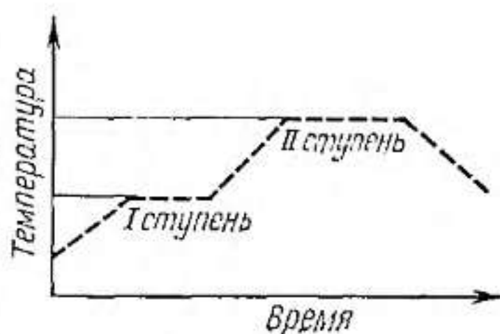
Рис. 4-29. Ход температурной кривой при термообработке ситаллов.
