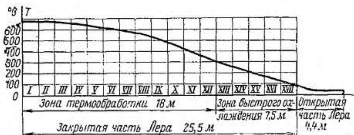
Рис. 4-28. Кривая отжига стеклянных штыревых изоляторов ШСС-10 из малощелочного стекла.
