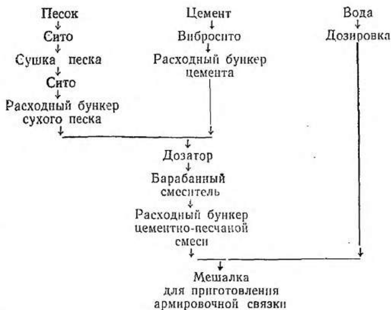
Рис. 5-1. Схема приготовления цементно-песчаной смеси и армирующей связки.
