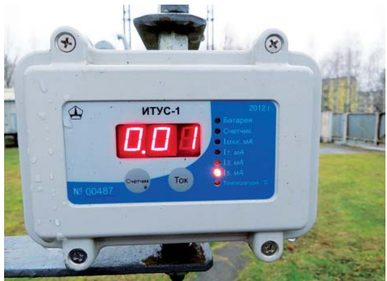
Рис. 1. Прибор контроля состояния параметров ОПН ИТУС-1
