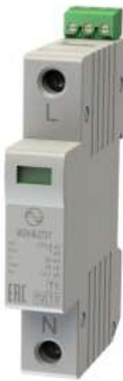
Однополюсные УЗИП класса испытаний I, II, III ограничивающего типа на основе металлоксидных варисторов предназначены для защиты электрооборудования, подключенного к проводникам L-PEN, L-N, L-PE однофазных или трехфазных низковольтных силовых распределительных сетей с системами заземления типа TN-C и TN-S, а также к проводникам L-N в системах ТТ. УЗИП применяются в качестве первой ступени защиты при кабельном и воздушном вводе электропитания.
