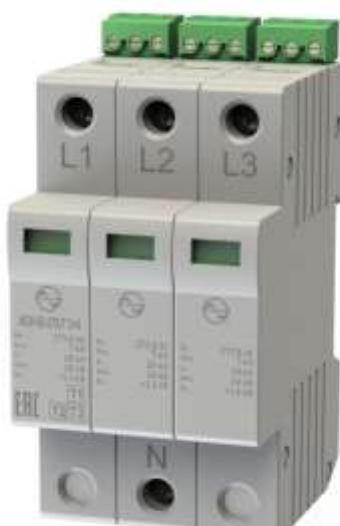
Трехполюсные УЗИП класса испытаний I, II, III ограничивающего типа на основе металлооксидных варисторов предназначены для защиты электрооборудования, подключенного к проводникам L-PEN, L-N, L-PE однофазных или трехфазных низковольтных силовых распределительных сетей с системами заземления типа TN-C и TN-S, а также к проводникам L-N в системах TT и IT.
