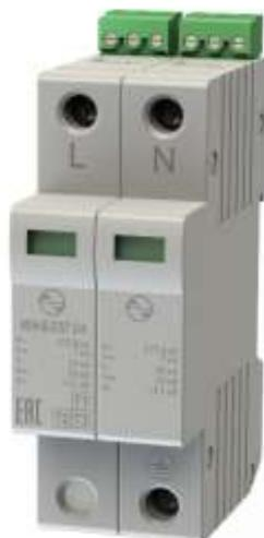
Двухполюсные УЗИП класса испытаний I, II, III ограничивающего типа на основе метало-оксидных варисторов предназначены для защиты электрооборудования, подключенного к проводникам L-PEN, L-N, L-PE однофазных или трехфазных низковольтных силовых распределительных сетей с системами заземления типа TN-C и TN-S, а также к проводникам L-N в системах TT. УЗИП применяются в качестве первой ступени защиты при кабельном и воздушном вводе электропитания.
