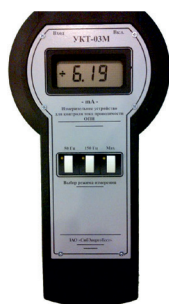
Рис. 61-2 Устройство контро- ля тока УКТ-03М
