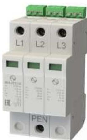
Трехполюсные УЗИП класса испытаний I, II, III ограничивающего типа на основе метало-оксидных варисторов предназначены для защиты электрооборудования, подключенного к проводникам L-PEN, L-N, L-PE однофазных или трехфазных низковольтных силовых распределительных сетей с системами заземления типа TN-C и TN-S, а также к проводникам L-N в системах TT. УЗИП применяются в качестве первой ступени защиты при кабельном и воздушном вводе электропитания.
