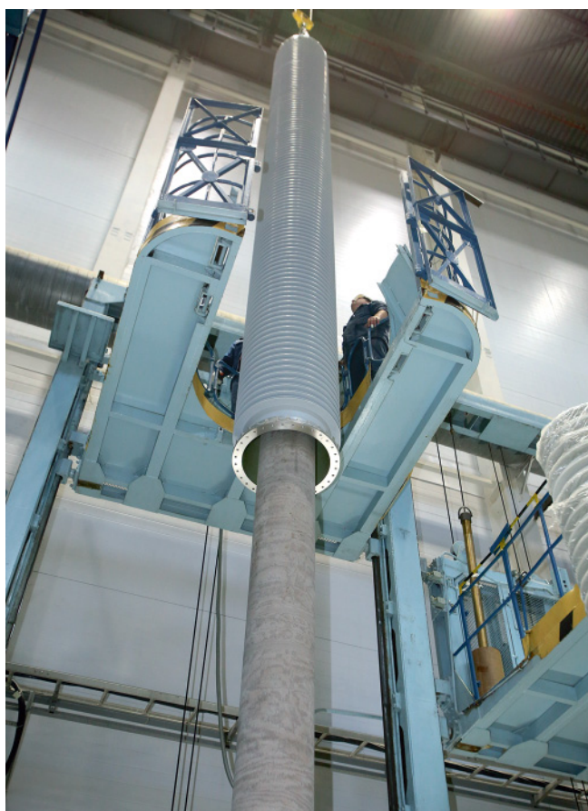
Монтаж внешней изоляции ввода — композитной покрывки
