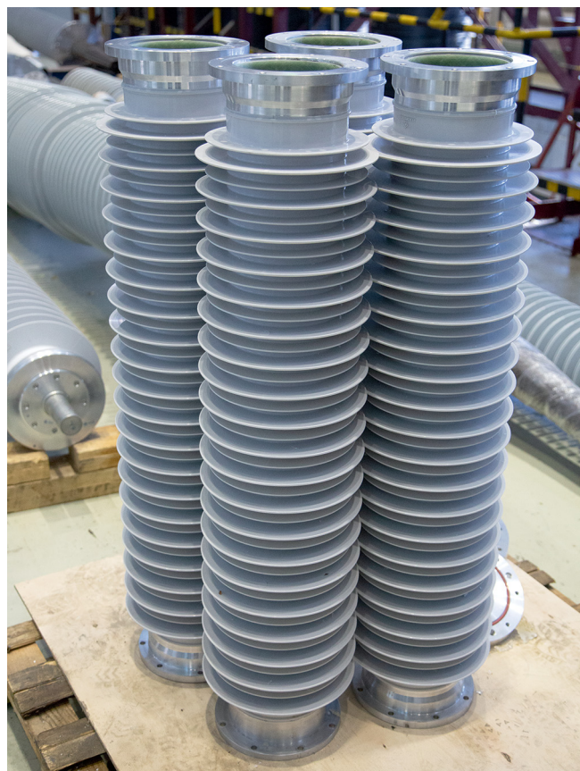
Опытные образцы полых композитных изоляторов класса напряжения 110 кВ
