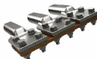
Зажимы аппаратные прессуемые типа 3А4А (с 4 отверстиями в контактной лапке)
