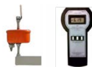
Диагностика состояния ОПН с помощью датчика тока проводимости ДТУ-03 и устройства контроля тока УКТ-03
