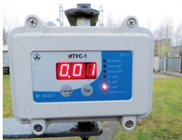
Рис. 1. Прибор контроля состояния ОПН — ИТУС-1
