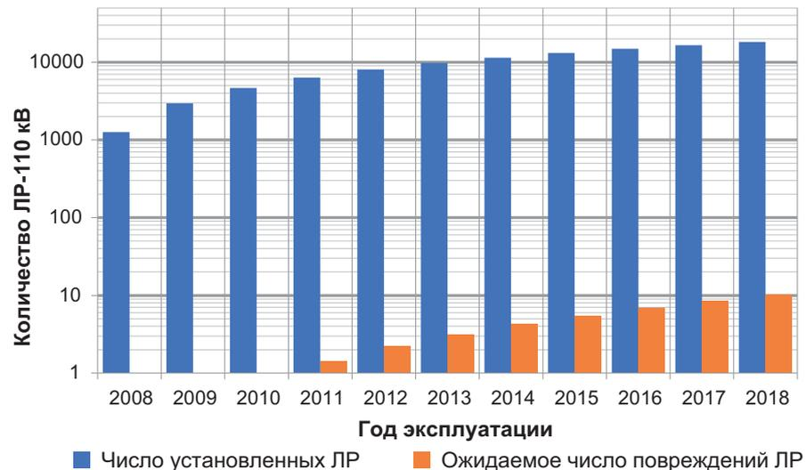
Рис. 7. Количество установленных разрядников и ожидаемое ежегодное количество поврежденных ЛР-110 кВ
