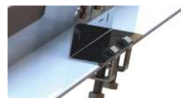
Крепление устройства на горизонтальную полку траверсы
