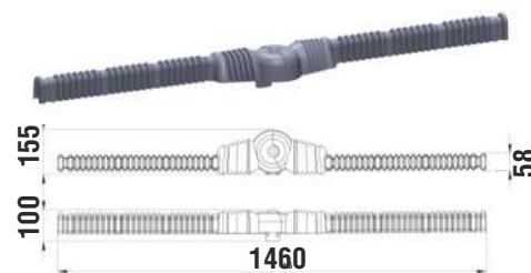
Общий вид и габаритные размеры ПЗУ-IL-PA
