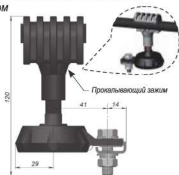
Рис. 8. ОПН исполнение С5 В комплекте с прокалывающим зажимом
