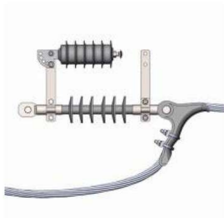
Рис.32.5 Монтаж разрядников на натяж- ную гирлянду изоляторов ЛК
