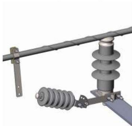
Рис.32.5 Монтаж разрядников на натяж- ную гирлянду изоляторов ЛК
