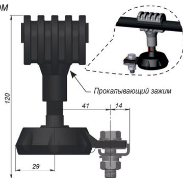
Ограничители предназначены для защиты от индуктированных грозовых перенапряжений изоляции электрооборудования и аппаратов, установленных на опорах ВЛ; ответвлений от магистрали к вводам в здания; изоляции воздушной линии. Ограничители поставляются в сборе с прокалывающим зажимом для монтажа на самонесущие изолированные провода СИП-4 сечением от 16 до 150 мм<sup>2</sup>. Прокалывающие зажимы являются одноразовыми.
