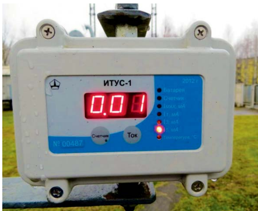
Рис. 1. Прибор контроля состояния параметров ОПН ИТУС-1
